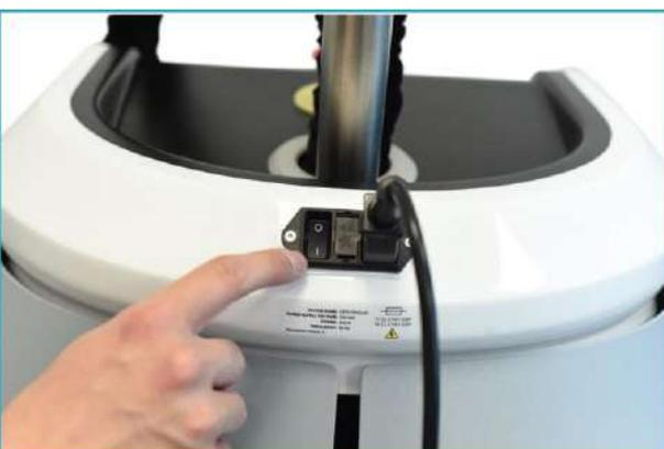
ALLUMEZ L'APPAREIL EN PRESSANT LE BOUTON D'ALIMENTATION SITUÉ À L'ARRIÈRE DE L'APPAREIL.
