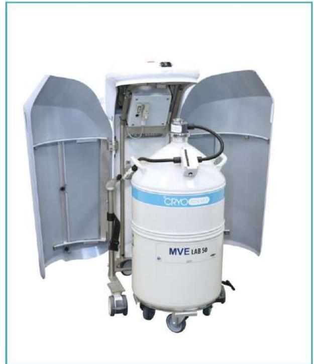
SORTEZ SOIGNEUSEMENT LE RÉSERVOIR D'AZOTE LIQUIDE DU BÔTIER DE L'APPAREIL ET DÉPLACEZ-LE LENTEMENT VERS L'ENDROIT OÙ IL SERA REMPLI.
